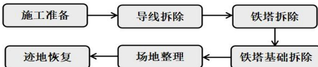
图 2-6 拆除输电线路施工工艺流程
