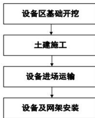
图 2-3 变电站扩建工程施工工艺流程
