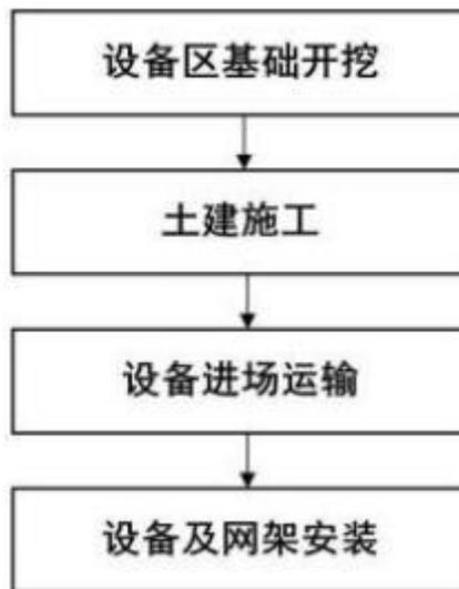
图 2-5 变电站扩建间隔工程施工工艺流程
