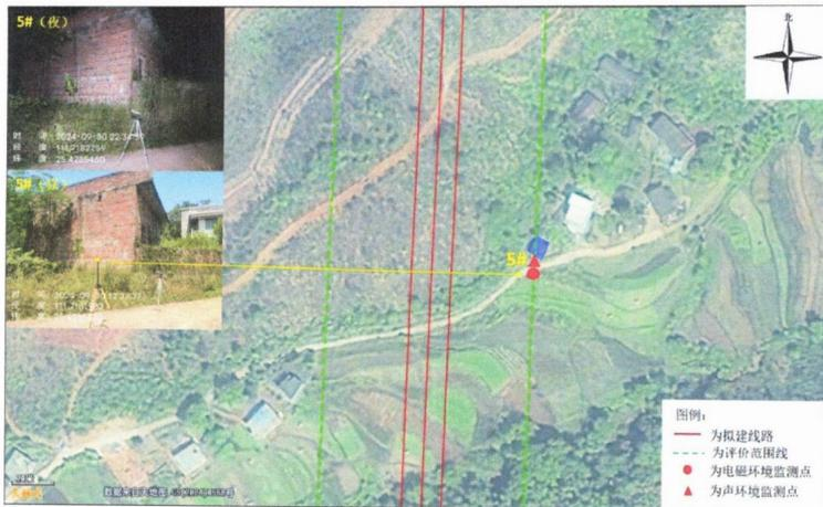
附图 4 检测点位布点示意图 (测点 5)
