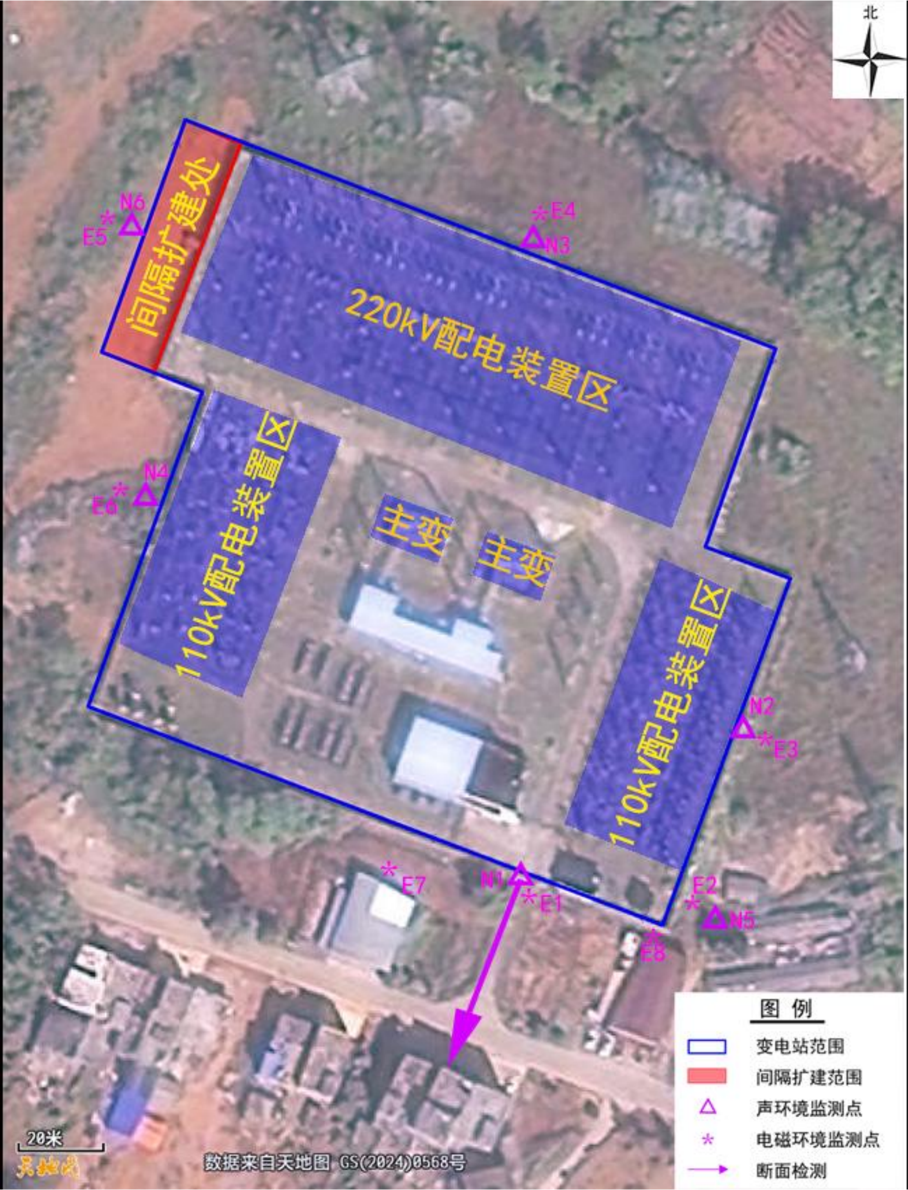
附图3 本工程平面布置及监测点位示意图
